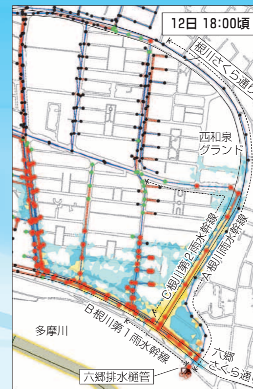
②BとCのバックウォーター現象は引き続き起こっていて浸水が広がっています。一方でA根川雨水幹線は順流のため、順調に多摩川へ排水できています。この後石原水位観測所水位が計画高水位を超えたため、安全を考慮して12日19:30に職員は退避しました。引き続き降雨が見込まれたこと、多摩川への流れが確認できたことにより、六郷排水樋管は開門のままとしました。
