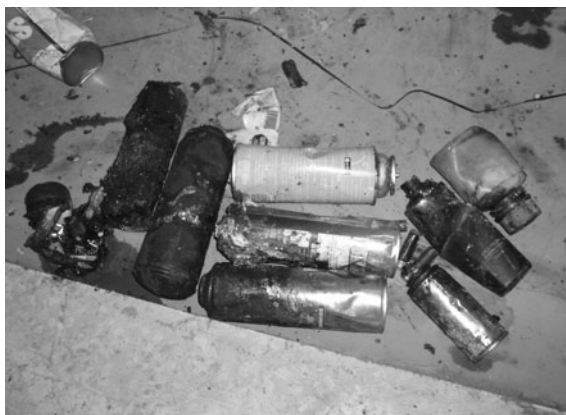
■平成19年10月19日の火災 不燃ごみの中から見つかったスプレー缶等
