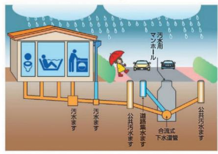
合流式下水道とは、雨水と汚水を同じ下水道管で排水する方式の下水道のことです。1本の管で済むため、建設費が安く、維持管理がしやすいのが、特徴です。
