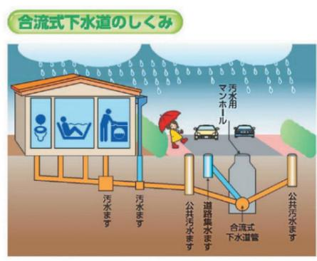
合流式下水道とは、雨水と汚水を同じ下水道管で排水する方式の下水道のことです。1本の管で済むため、建設費が安く、維持管理がしやすいのが、特徴です。
