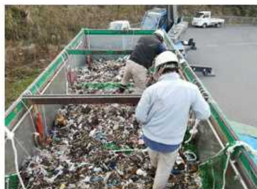
写真3 試料を投入した後の生物乾燥実証槽の上部
